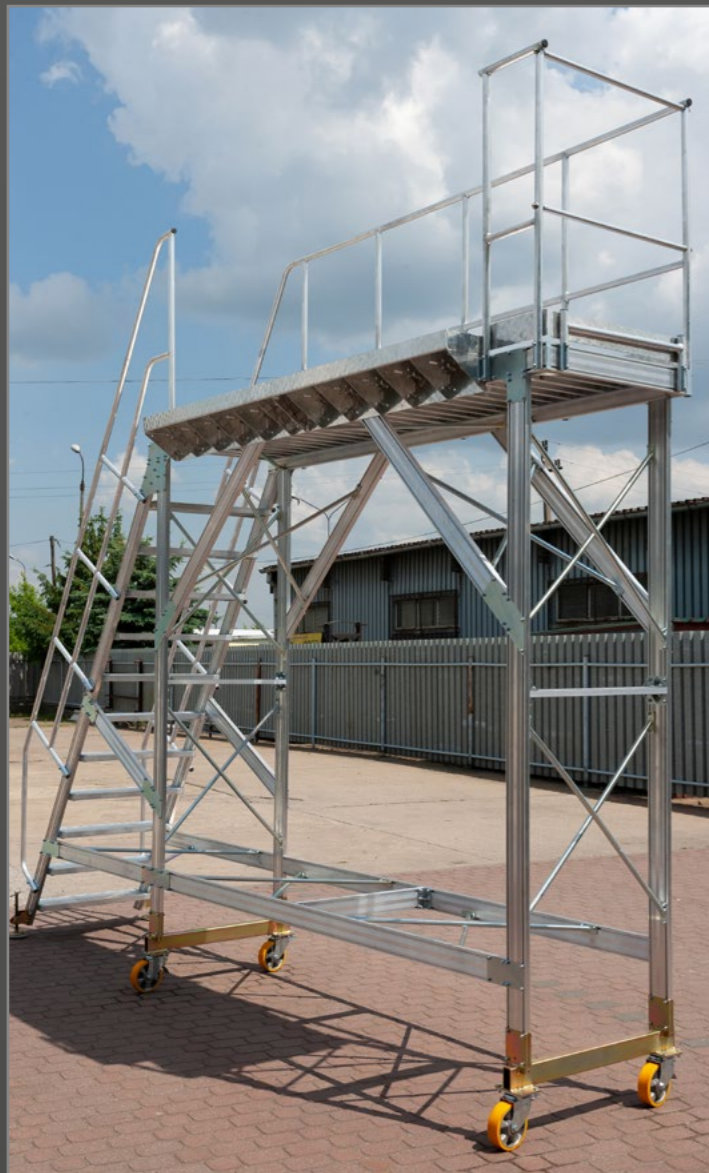
Schody do obsługi pojazdów szynowych
