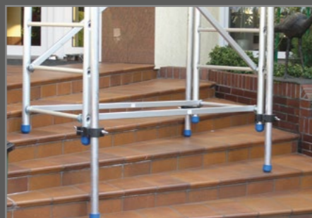
Podpora schodowa nr kat. 410.10. Służy do ustawienia rusztowania na podłożu o różnych poziomach (RA 330). Możliwość regulacji do 600 mm.
