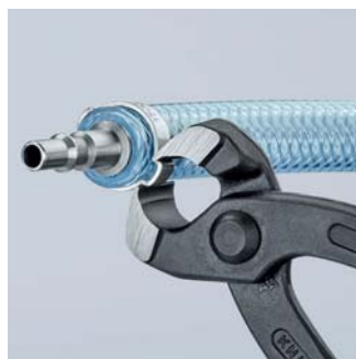
Uszczelnianie połączeń pneumatycznych w szybkozłączkach
