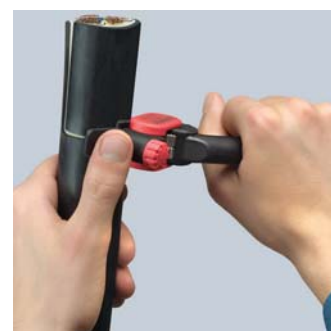
Cięcie po obwodzie
