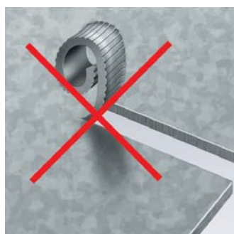
Wykrawanie bez łamania wiórów
