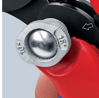
Zmiana zakresu zagniatania z 10 mm 2 na 16 mm 2 odbywa się za pomocą przełącznika.
