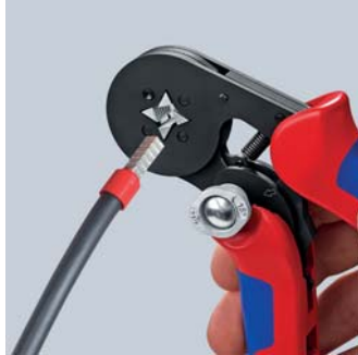
Zmiana zakresu zagniatania z 10 mm 2 na 16 mm 2 odbywa się za pomocą przełącznika.
