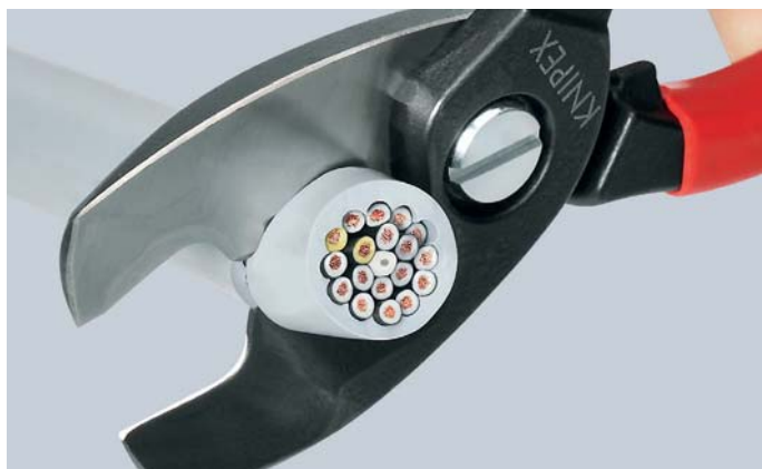
Docięcie: jeżeli do przecięcia kabla wymagana jest większa siła, można użyć ostrza znajdującego się w pobliżu złącza nożyc. Cięcie wstępne za pomocą ostrza przedniego – docięcie za pomocą ostrza tylnego
