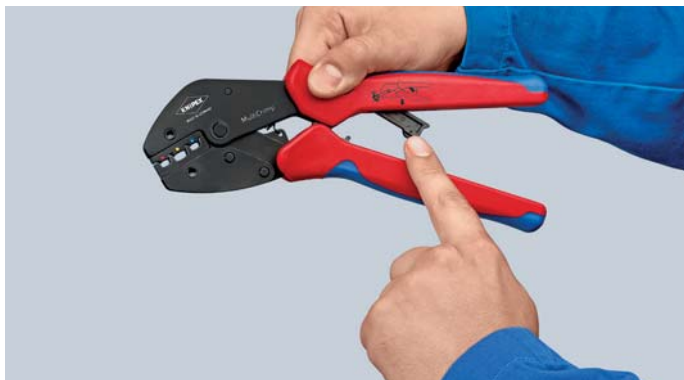
Złożyć dźwignię serwisową i zaciśnąć szczypce – w ten sposób szczypce są gotowe do następnego zadania
