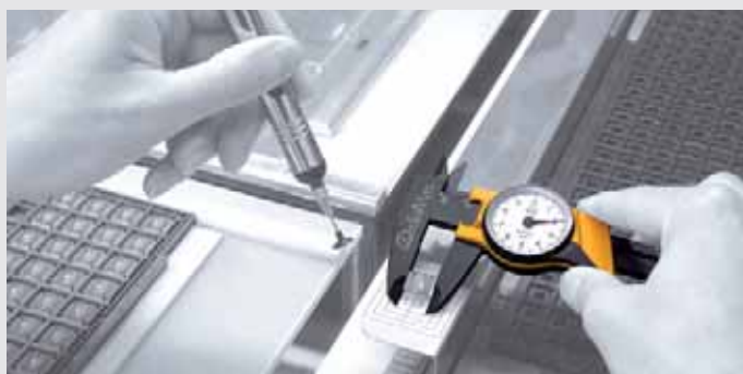
Suwmiarka dialMax ESD umożliwia prace pomiarowe we wrażliwych miejscach części elektronicznych.
