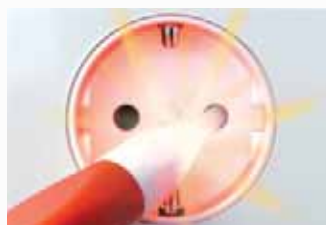
Próbnik rozpoznaje fazę i przewód zerowy.
