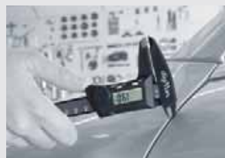
Szczęki pomiarowe suwmiarki wzmocnionej włóknem szklanym umożliwiają pomiar bez zarysowań w miejscach wrażliwych na powierzchniach błyszczących.
