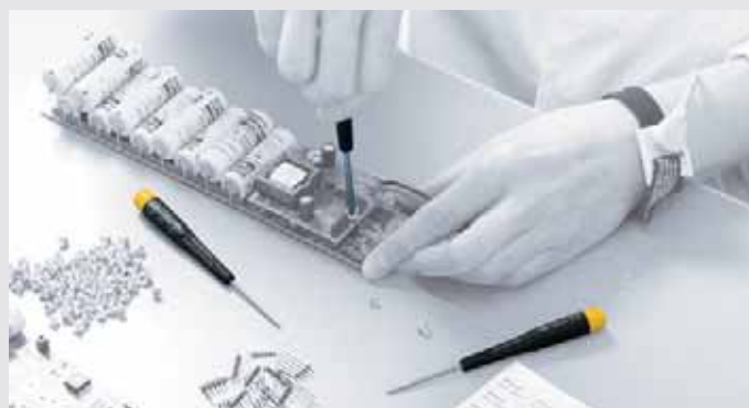
Dyssypacyjne narzędzia Precision ESD chronią wrażliwe elementy konstrukcyjne.
