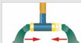
Prosta wymiana zużytych bijaków: 1. Zamocować młotek w imadle i wyjąć stary bijak przez uniesienie go. 2. Wcisnąć nowy bijak w imadło.
